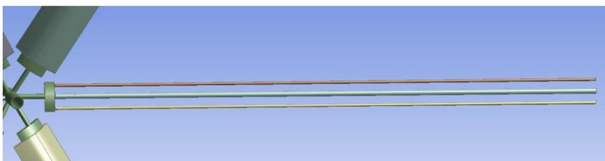
Рисунок 78. Модель ветряка (внутренние ребра жесткости в лопасти)
