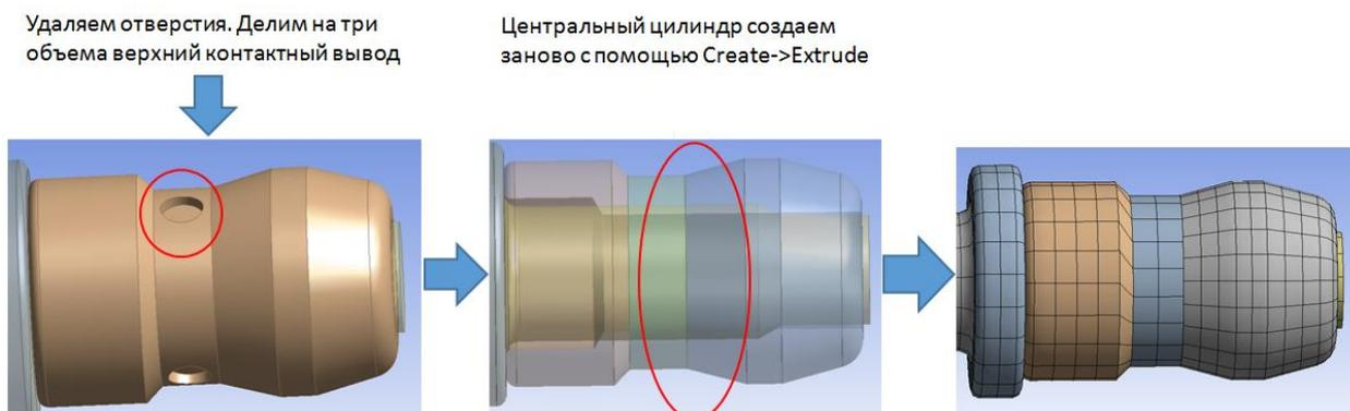
Рисунок 43. Пример упрощения геометрии
