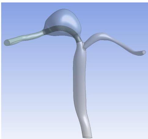
Рисунок 2. Трехмерная модель сосуда виллизиевого круга с аневризмой и установленным стентом
