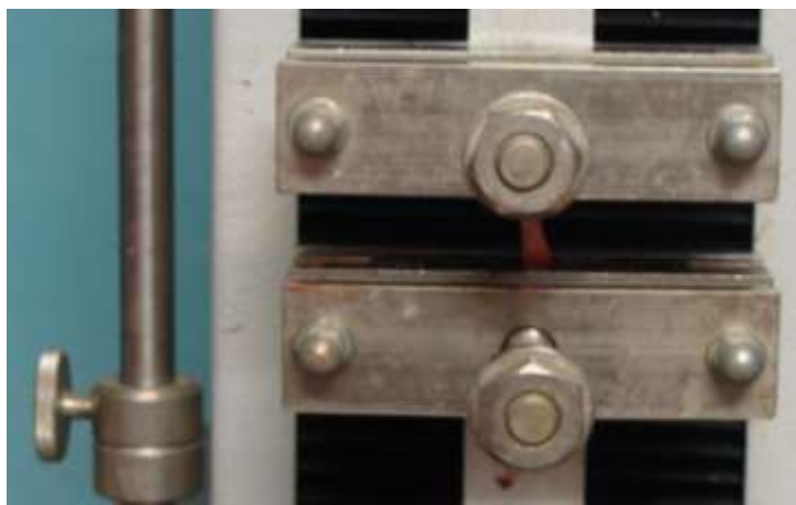
Рисунок 7.3 – Разрывная машина с закрепленным образцом растягиваемой артерии.
