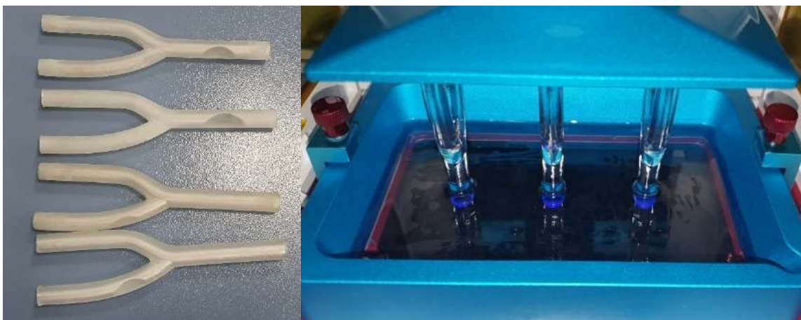
Рисунок 10.6 – Фотография готовых полимерных моделей сосудов с сужениями разной конфигурации и местоположения (слева) и моделей в 3D принтере в процессе «выращивания» (справа).
