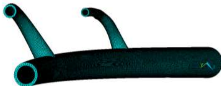
Рисунок 9.12 – Модель стенки сосуда, разбитой конечно-элементной сеткой.
