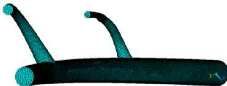
Рисунок 9.13 – Модель объема крови в сосуде, разбитая конечно-элементной сеткой.
