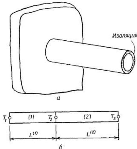
На свободном конце стержня происходит теплообмен с окружающей средой. Коэффициент теплообмена  $h$ , температура окружающей среды  $T_\infty$ .
