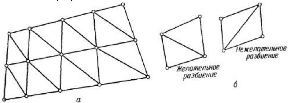
В задачах, когда присутствуют концентрации напряжений, особенности геометрии и т.п. стараются не делать равномерные разбиения. Возможность варьирования размеров элементов является одним из достоинств МКЭ.
