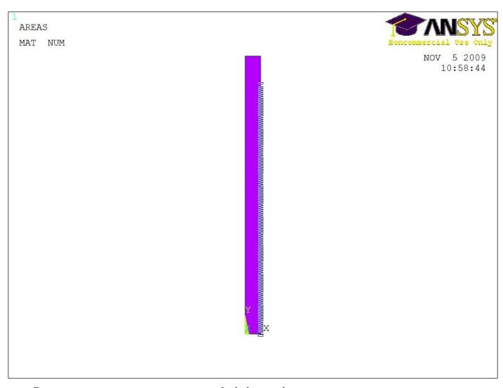
В следующем окне снимаем галочку *Include initial penetration* и устанавливаем значение коэффициент трения *Coefficient of Friction* (в нашем случае 0.15). *Material ID* устанавливаем в значение 2, т.к. этот набор материалов обладает меньшим значением модуля упругости.
