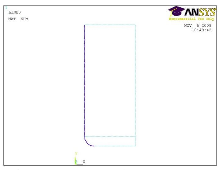
Теперь указываем контактную поверхность, выбрав соответствующие узлы, например, командой **NSEL**. Тут же указываем тип контакта *Surface-to-Surface* (поверхность к поверхности).
