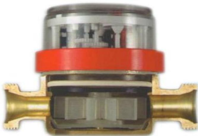
Встала задача об уменьшении металлоемкости нижней части счетчика. Было решено уменьшить диаметр нижней части счетчика, а также диаметр крыльчатки. При такой постановке помимо крыльчатки должна быть изменена и верхняя часть, содержащая в себе счетный механизм. Так как изменяется диаметр крыльчатки, то меняется и скорость ее вращения по сравнению со стандартным счетчиком при неизменном расходе воды.
