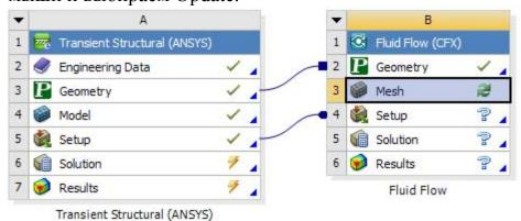
9. Задаем параметры анализа для Fluid Flow. Заходим в Mesh. В дереве проекта открываем вкладку Model(В3) → Geometry. Исключаем из анализа объем, соответствующий твердому телу. Нажимаем правой кнопкой мыши на Solid, выбираем Suppress Body.
